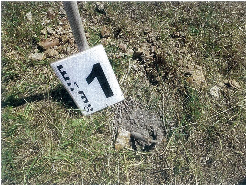
Bohrloch nach oben mit Quellton abgedichtet
